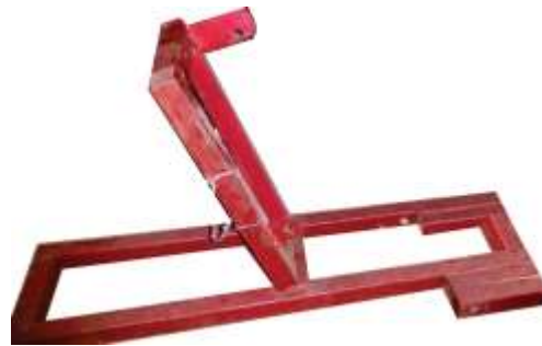
Figura 5: Base metálica de metalon soldada e pintada. (Fonte: autor)
