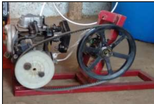
Figura 4: Gerador de energia elétrica construído com motor de roçadeira (Fonte:autor)
