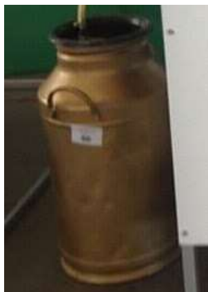
Figura 7: Biodigestor em recipiente metálico. (Fonte: autor)
